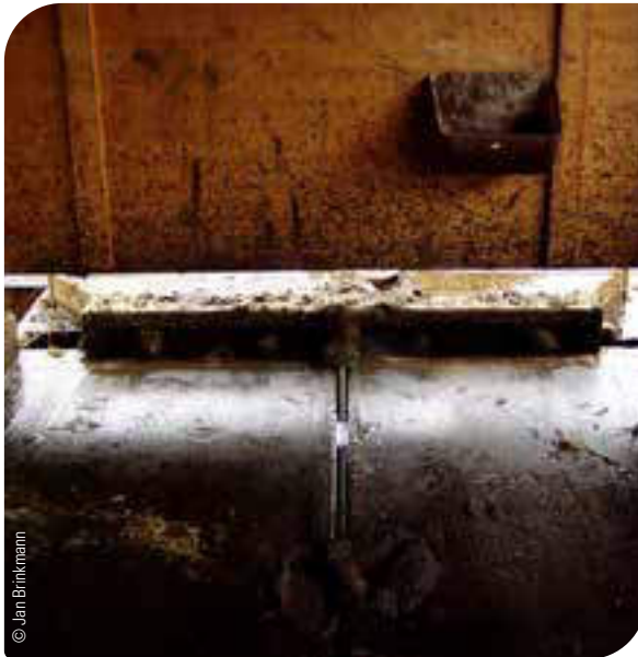
Abb. 62: Entmistungsschieber im Ruhezustand außerhalb des Tierbereichs
